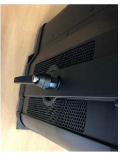
Klemmen hoeven steeds verticaal staan
